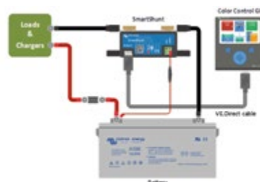
Conexión de un SmartShunt a un dispositivo GX
